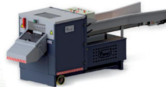
Verstärkte Guillotine Schneidemaschine für Spezial Fasern.
