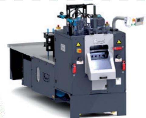
Guillotine Schneidemaschine für Präzisions-Kurzchnitt (Flockfasern, Armierungsfasern, Faserfüllstoffe, Pulp, ...).
