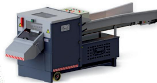
Cortadora guillotina reforzada para fibras especiales.
