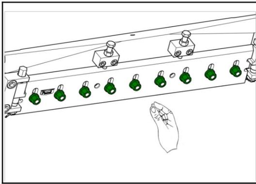
22 Durch Drehen der beiden Einstellschrauben das Messer in die oberste Position bringen.
