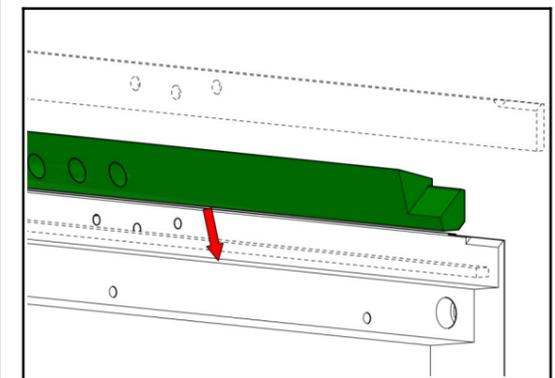
16 Mittlere Schraube einsetzen, ohne diese festzuziehen.
