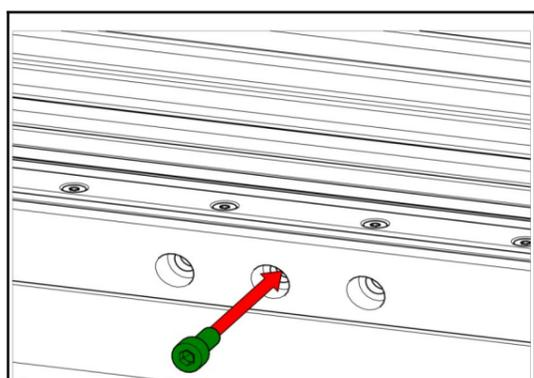
17 Die Schrauben der beiden Halterungen festziehen.
