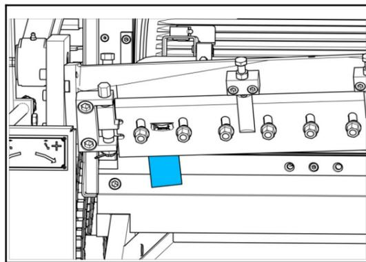
28 Die Riemenscheibe bewegen. Die linke Einstellschraube drehen, bis das Papier eingeklemmt ist.
