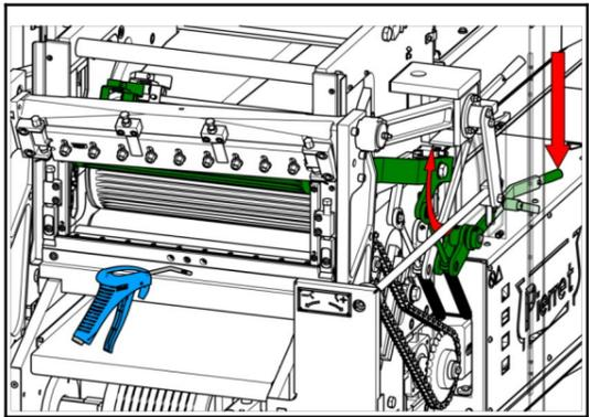
8 Messeranschlüsse des beweglichen Messers entfernen.
