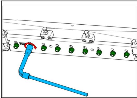
32 Die Anschläge des beweglichen Messers einsetzen und nur leicht anziehen, dann kontern.
