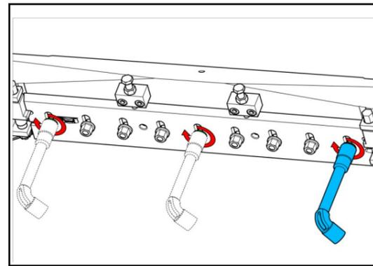
24 Die Messereinstellungen (li/re) bis zum Anschlag in die Richtung "-" und dann 5 Umdrehungen in Richtung "+" drehen.
