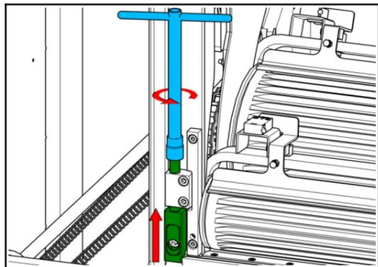
12 Mittlere Schraube des feststehenden Messers entfernen.
