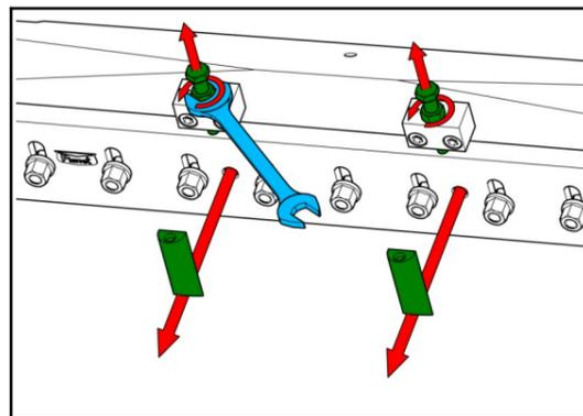
9 Alle Muttern entfernen, ausser der Mittleren.
