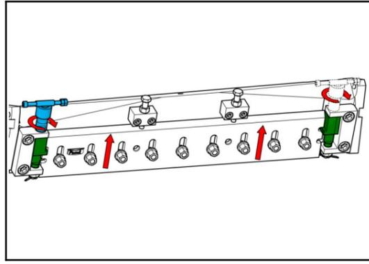
23 Die mittlere und die beiden äußeren Muttern leicht an ziehen.
