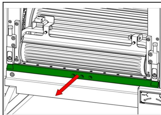
14 Die Stellen reinigen, an denen die Messer anliegen. Gegebenenfalls mit Schleifpapier.
