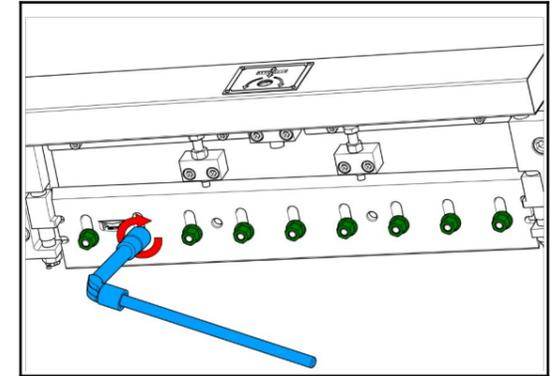
31 Die Anschläge des beweglichen Messers einsetzen und nur leicht anziehen, dann kontrollieren.
