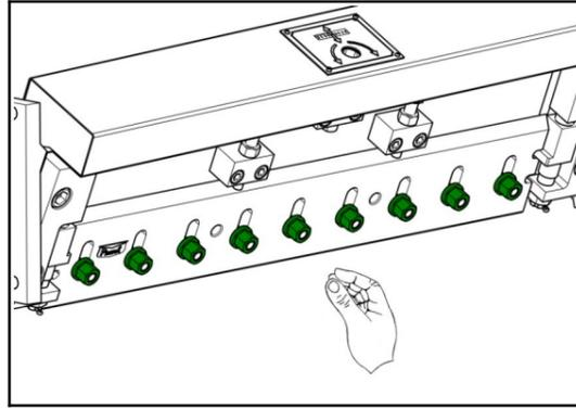
23 Die Messereinstellungen (li/re) bis zum Anschlag in die Richtung "-" und dann 5 Umdrehungen in Richtung "+" drehen.
