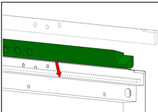
17 Mittlere Schraube einsetzen, ohne diese festzuziehen.
