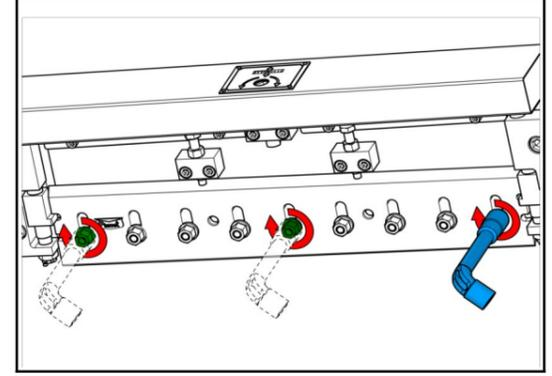
26 Den Messerträger in die Einstellposition bringen und Sicherheitsbolzen wieder einsetzen.
