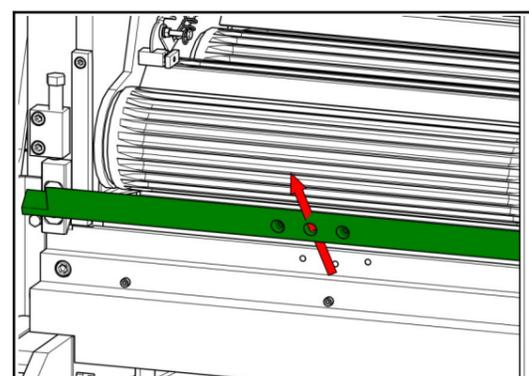
15 Die Stellen reinigen, an denen die Messer anliegen. Gegebenenfalls mit Schleifpapier.
