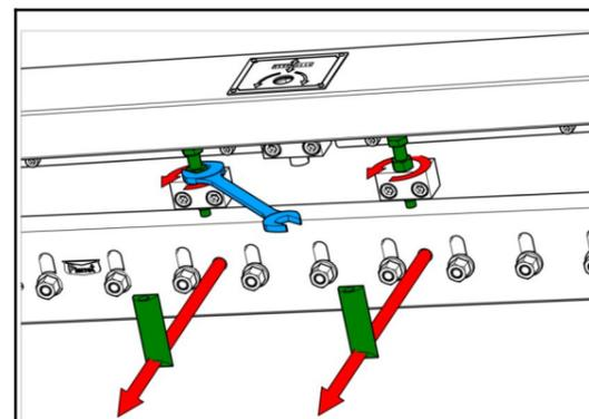
10 Alle Muttern entfernen, ausser der Mittleren.
