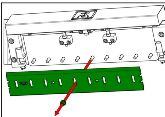
12 Die Schrauben lösen und die Halterungen nach oben bewegen.
