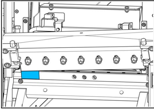
28 Die Stange in die linke Seite der Kurbelwelle einsetzen.
