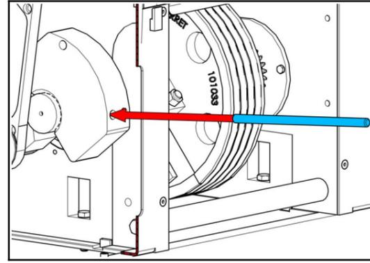
29 Die Stange bewegen. Die linke Einstellschraube drehen, bis das Papier eingeklemmt ist.
