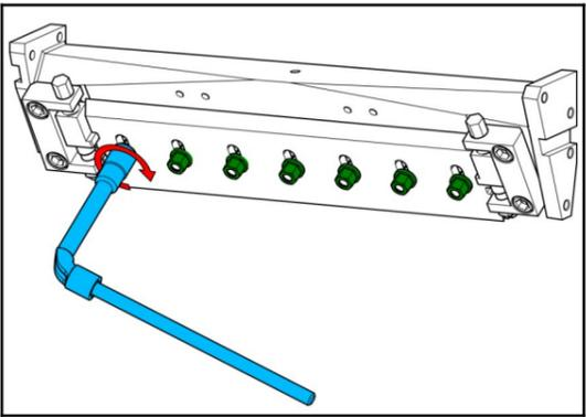
33 Eine volle Umdrehung des Schneidsystems manuell durchführen (in Pfeilrichtung).
