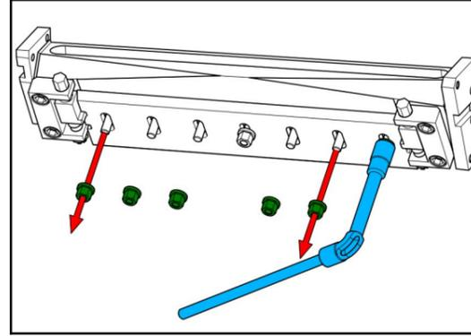
10 Mantener la cuchilla móvil, retirar la tuerca central y retirar la cuchilla.
