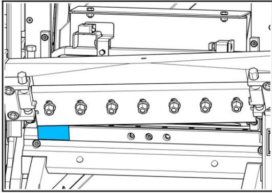
28 Insertar la barra en la parte lateral izquierda del cigüeñal.
