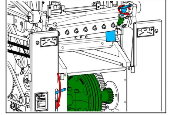
31 Repetir el ajuste en los lados izquierdo y derecho con 4 capas de papel y luego 2 capas.
