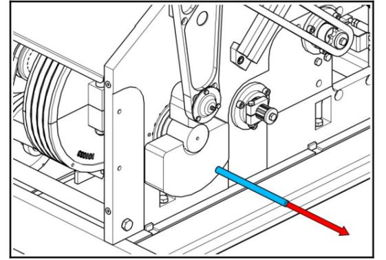
26 Girar el volante para colocar el porta-cuchillas en la posición inferior.
