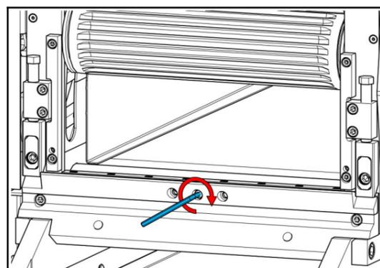
19 Ajustar las dos guías de material a  $\pm 1$ mm de distancia de la cuchilla fija.
