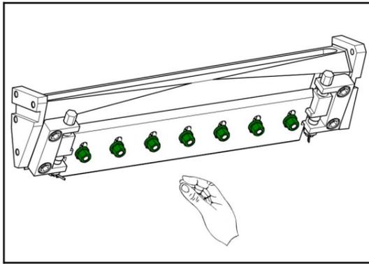
22 Girar los tornillos de ajuste para posicionar la cuchilla en el punto más alto del porta-cuchillas.
