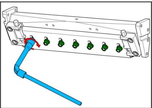
33 Dar manualmente un giro completo del sistema de corte (dirección de la flecha).
