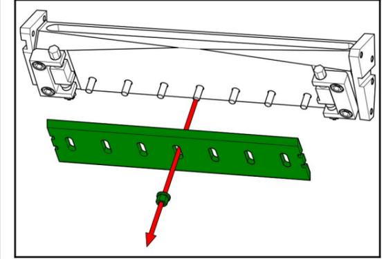
11 Aflojar los tornillos y mover las abrazaderas hacia arriba.
