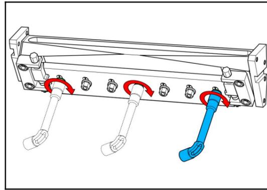
24 Girar las manecillas de ajuste completamente en el sentido - y después 5 vueltas en el sentido +.
